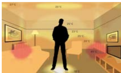
Распределение тепла от обычной системы отопления с радиаторами. Значительный разброс температур (18–35°C) в комнате.
