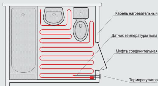
В случае, если вы не планируете увеличивать строительную высоту пола, используйте тонкие нагревательные маты: **DEVIheat™ 150S**, **DEVIcomfort™ 150T**, **DEVImat™ 150T**, **DEVImat™ 200T**, которые устанавливаются в слой плиточного клея толщиной 4-7 мм. В сочетании с новым терморегулятором вы получите отличную систему «теплый пол».
